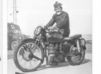
Des ressorts à l'extrémité de garde-boue de la Velocette donnaient une position auto-centrée pour grignoter des secondes sur le très rapide circuit de Reims (1949).
